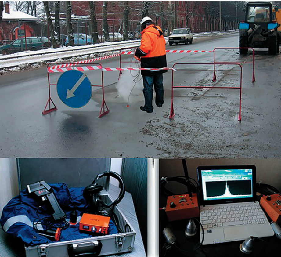
Рис. 4. Наземное обследование аномальных участков методами акустометрии
