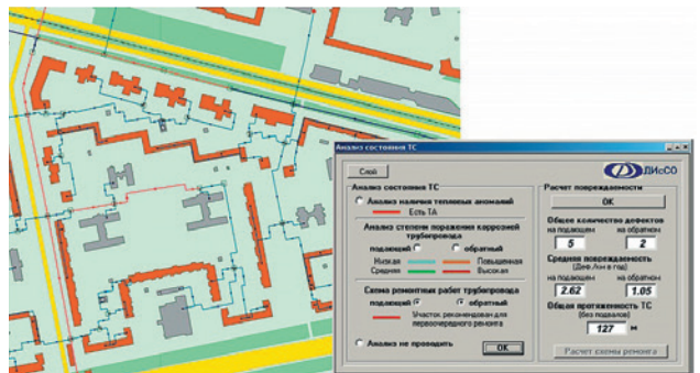
Рис. 6. Фрагмент адресной программы ремонтных работ, составленной на основании классификации эксплуатационного состояния подземных теплопроводов
